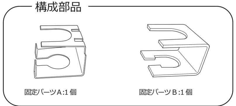
JB64ジムニーは、JB74シエラよりブレーキホースが短いため、KONIショックを取り付けると特定の条件下(※1)でブレーキホースが、伸び切ってしまう場合があります。このため付属したブレーキホース固定位置移動部品を装着し、固定位置を下側へ移動して、伸び切りを防止してください。
