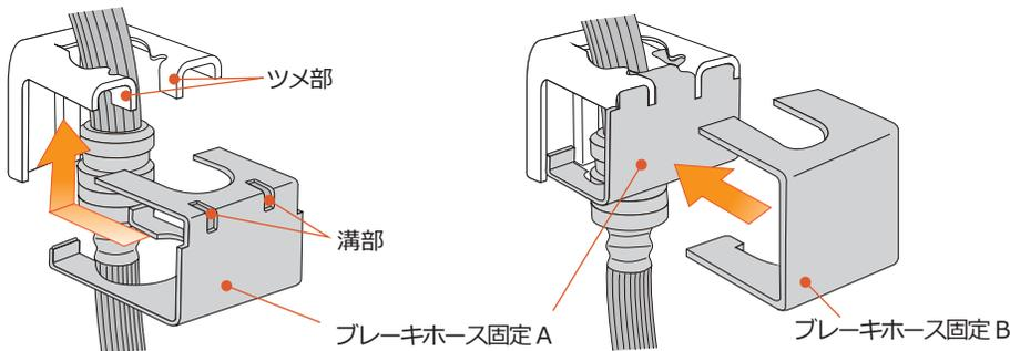
②-1 車両のホースマウントステーのツメ部に固定パーツ A の溝部を組み合わせてください。
